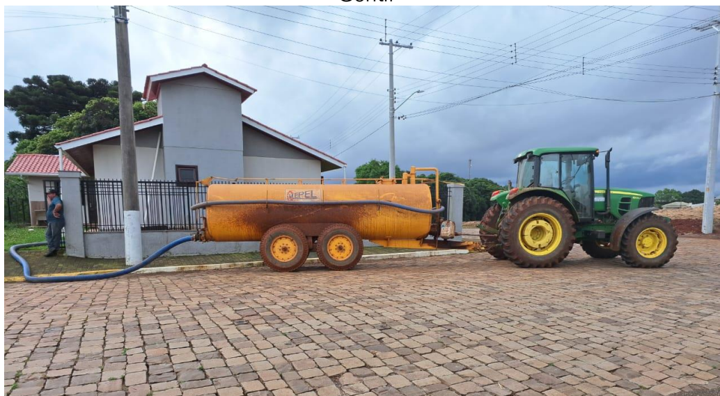
Figura 52 - Veículo e equipamento utilizado para a limpeza de fossas no município de Gentil
