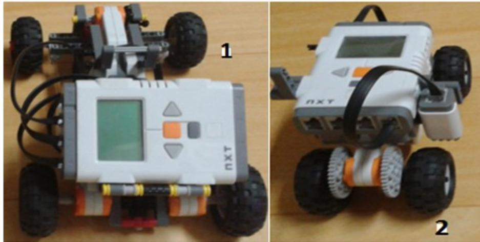
O professor realiza, em seguida, um sorteio para definir quais equipes farão a montagem do carro de corrida com três motores e quais equipes montarão o carro com engrenagens com um único motor. O objetivo da programação nesta fase é fazer com que cada robô realize o movimento em linha reta, subindo e descendo a rampa, como mostra a figura 6.
