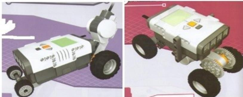
Após a montagem dos robôs, as equipes enfrentam o desafio de fazer seus robôs executarem o percurso da figura 3, que é uma pista reta em material liso. O professor pode filmar todos os momentos para registrar os resultados da atividade, montagem, programação em 3 níveis força de rotação, (30, 60, 100) testes e ajustes onde os estudantes poderão visualizar na prática a diferença entre as forças programadas. A pontuação de cada equipe só é conhecida na conclusão das atividades.
