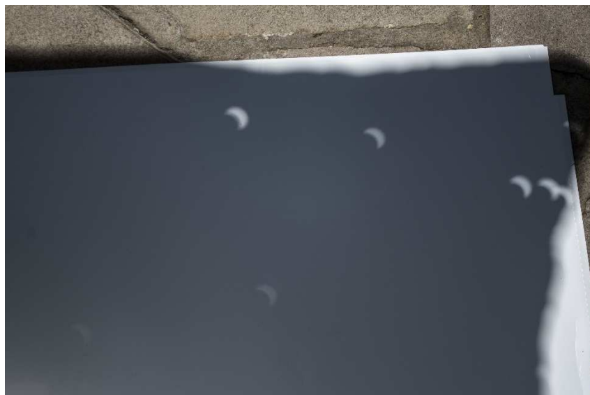
Figura 9. Essa é uma imagem rara. Temos novamente imagens múltiplas do Sol, desta vez obtidas pela passagem dos raios de luz através de orifícios em uma lamina de alumínio, a uns três metros de altura do solo. É possível identificar sete imagens; as imagens mais fracas correspondem a orifícios de menor diâmetro. São 7 orifícios ao todo. Nesse dia (26 de fevereiro de 2017) e horário (aproximadamente 11 h da manhã, em Caxias do Sul, RS) ocorria um eclipse solar, por isso as imagens lembram imagens da lua.
