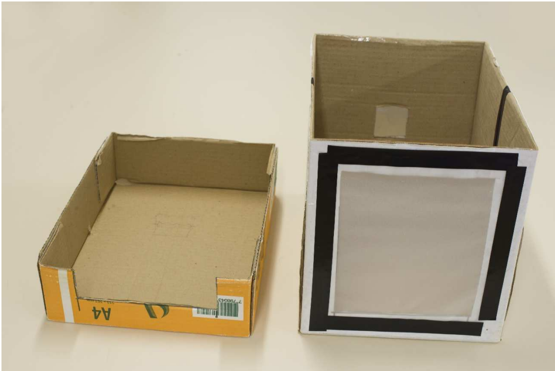
Figura 2: a câmara escura, parcialmente pronta. Um anteparo de papel vegetal ocupa a parte da frente da caixa (à direita); na parte traseira, pode-se ver a janela, tapada por uma lâmina de papel de alumínio de 5 cm por 5 cm. No centro da janela de papel alumínio será feito um orifício com uma agulha. À esquerda, aparece a tampa da caixa.
