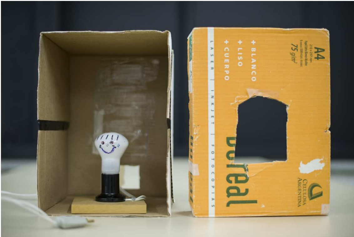
Figura 3: caixa que contém a lâmpada. A “cartera” pintada na lâmpada pode ser desenhada (com caneta do tipo “hidrocor”) pelos próprios alunos, no início da atividade. A tampa, à direita é colocada durante o uso da câmara, com o objetivo de limitar ainda mais a luz espalhada no ambiente.
